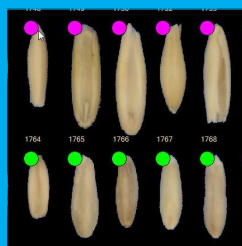
オート麦の解析例： 表皮の残った粒と 取り除いた粒との判別
