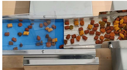
バイブレーションユニットによる均一なベルトへの分配
